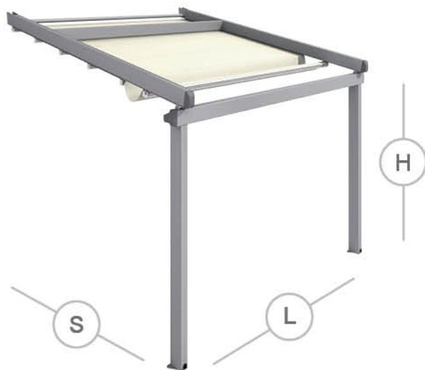
Struttura portante in alluminio verniciato con attacco a parete o a soffitto da un lato, e appoggio su profilo portante mm 150 x 92 completo di gambe mm 150 x 92 con fissaggio a terra.
