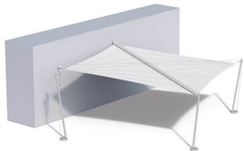
Tre alberi fissati a terra e un punto di ancoraggio a parete
